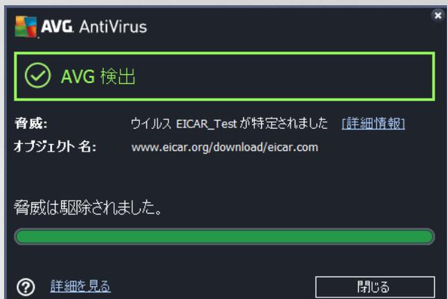
警告ダイアログでは、検出され感染と判断されたオブジェクトに関する情報（脅威）、および認められた感染の事実に説明（オブジェクトの名前）が表示されます。詳細リンクをクリックすると、[オンラインウイルス百科事典](#)に移動します。ここでは、既知のウイルスであれば、検出された感染の詳細な情報を調べることができます。ダイアログには次のコントロール要素があります。
